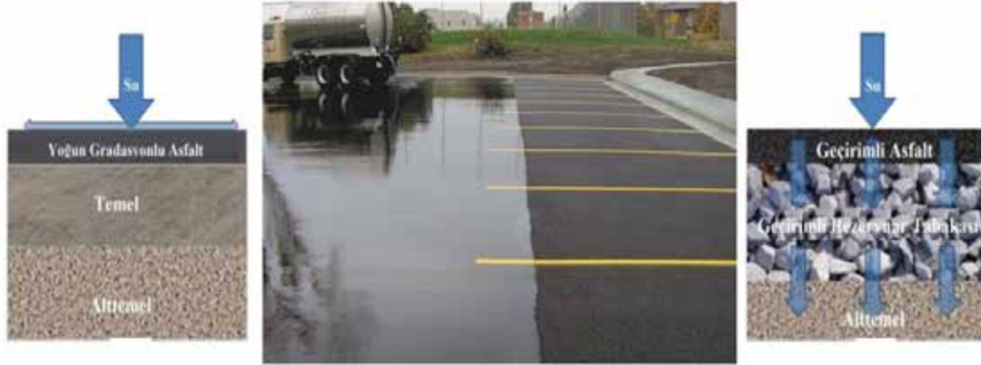
Şekil 2. Geleneksel ve geçirimli asfalt yüzeylerde drenaj (Topaloğlu, 2019)
