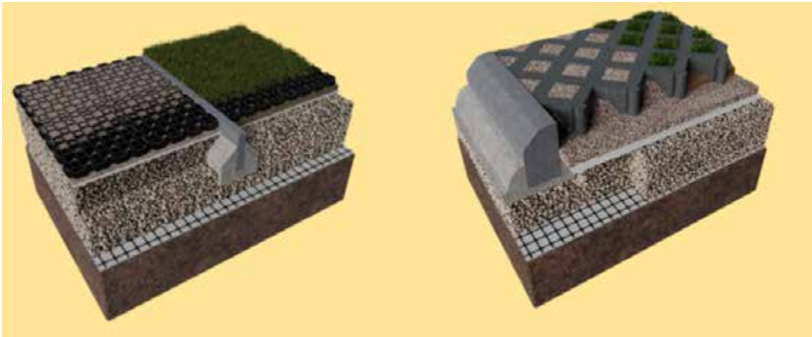
Şekil 4. Ekilebilir ve dolgu malzemeli plastik ve beton zemin güçlendirme ızgaraları kesiti (URL 8)
